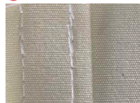
Résistance à l'arrachement 203 newtons
