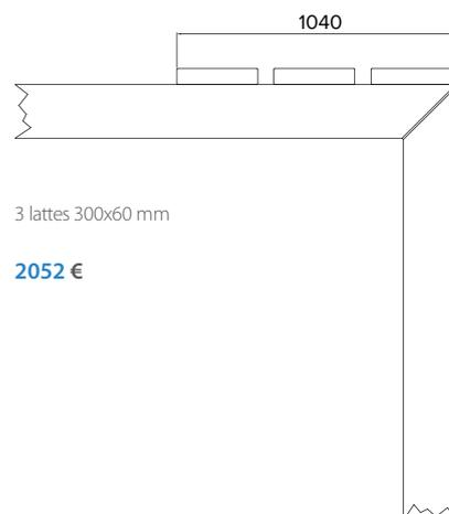
NOTE: la distance entre une série de lattes et la suivante ne peut jamais dépasser 6 mètres dans la travée.
